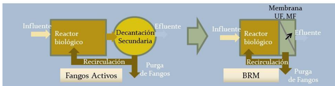
Figura 1. Evolución del proceso de fangos activos a biorreactor de membrana
